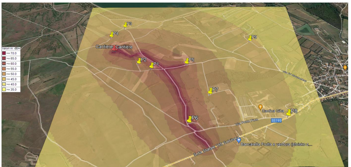
Figura 3 Le curve di livello simulano la propagazione del rumore durante l'attivazione di tutte le fonti di rumore MOV ed il passaggio dei Camion (valori espressi in dB).
